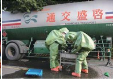
氯乙烯槽車止漏作業
