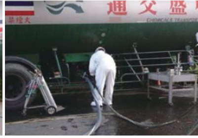
氯乙烯槽車移槽作業
